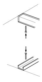
Slide top door recess onto top guide
